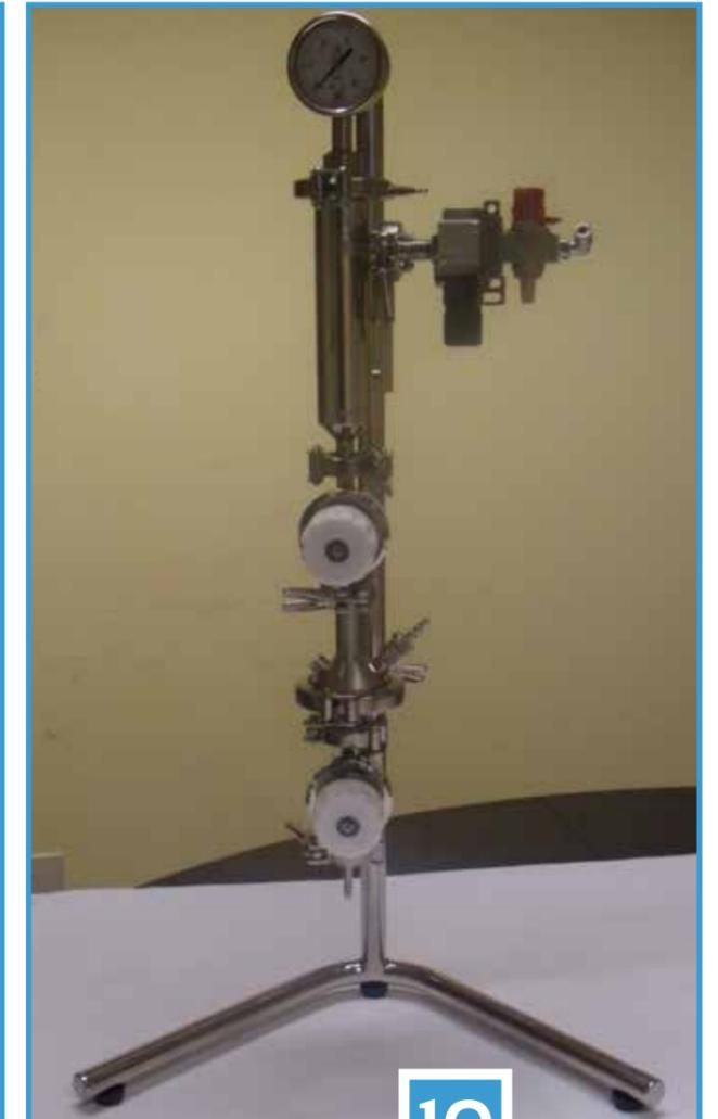
Il test di filtrabilità è uno strumento in grado di effettuare e calcolare automaticamente l'indice di filtrabilità delle cartucce filtranti. I risultati, sono ripetitivi e ripetibili grazie al grado di standardizzazione consentito dallo strumento. Si applica nella valutazione dell'efficienza dei vari sistemi di filtrazione.
