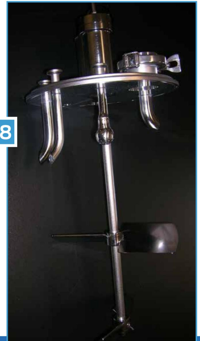
Il sistema di rotazione può essere realizzato con motorizzazione pneumatica o elettrica
